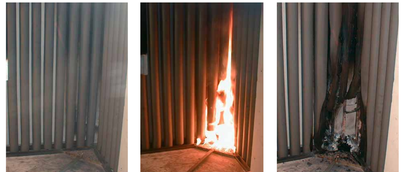
Abbildung 2: Der SBI-Test – hier am Beispiel von elastomeren Schläuchen – vor, während und nach dem Test
