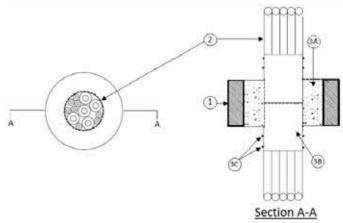
≤ 300 mm width < Ø 100 mm (conduits < 32mm)
