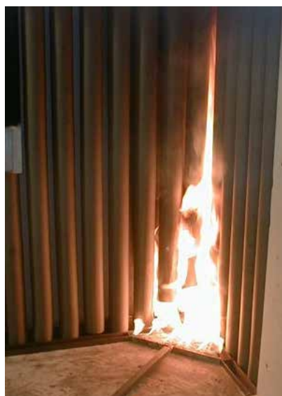
Figur 2: SBI-provning – som här visas med elastomeriska rör – före, under och efter testet
