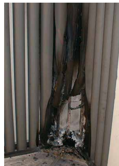
Figur 2: SBI-provning – som här visas med elastomeriska rör – före, under och efter testet
