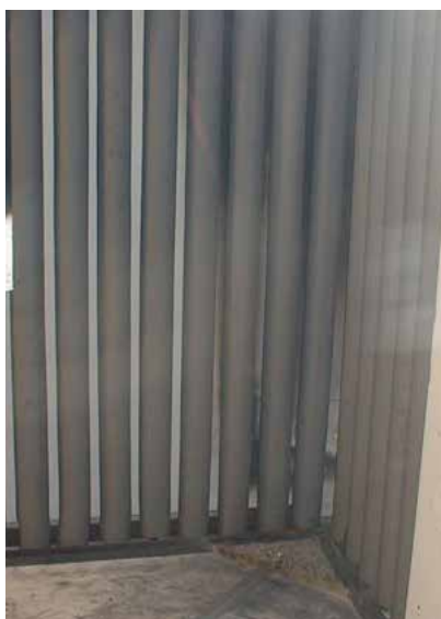
Figur 2: SBI-provning – som här visas med elastomeriska rör – före, under och efter testet
