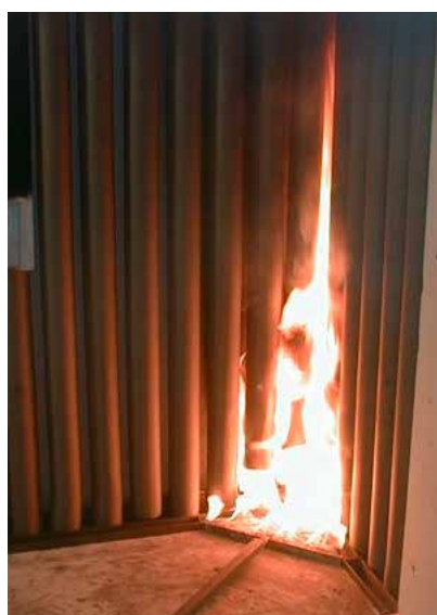
Figur 2: SBI-testen, vist her med cellegummislange, før, under og etter testen
