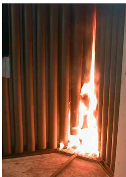
Figura 2: Il test SBI - qui illustrato con tubi elastomerici - prima, durante e dopo il test
