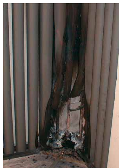
Figura 2: Il test SBI - qui illustrato con tubi elastomerici - prima, durante e dopo il test
