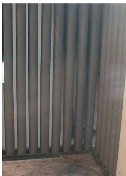
Figura 2: Il test SBI - qui illustrato con tubi elastomerici - prima, durante e dopo il test
