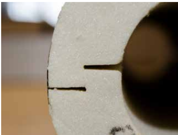
Les mousses PUR/PIR rigides ont une faible résistance à la transmission d'eau-vapeur et nécessitent donc une barrière contre la vapeur efficace.
