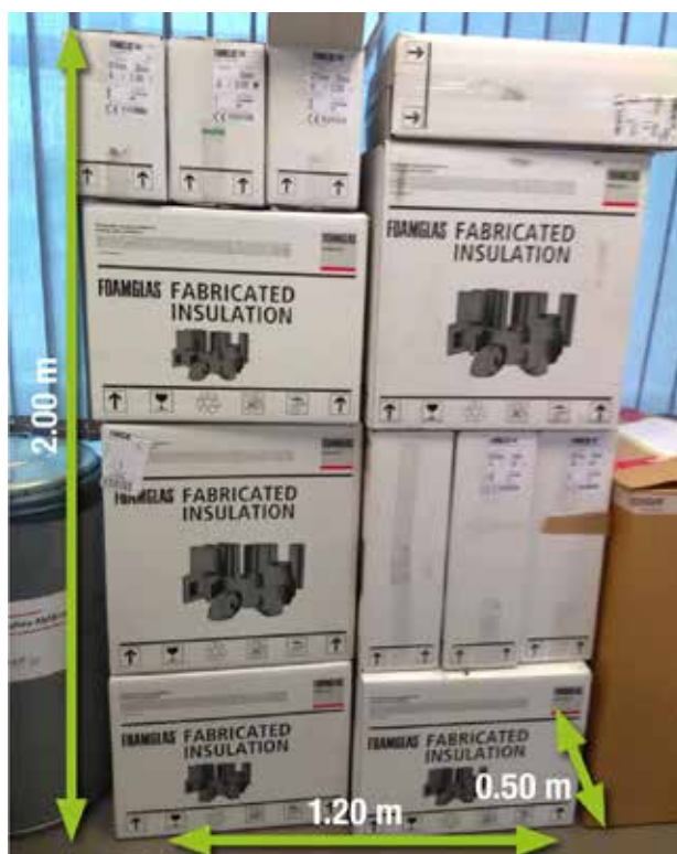
Plutôt encombrant : quand on utilise du verre cellulaire, il faut prévoir suffisamment d'espace dans le site de construction.
