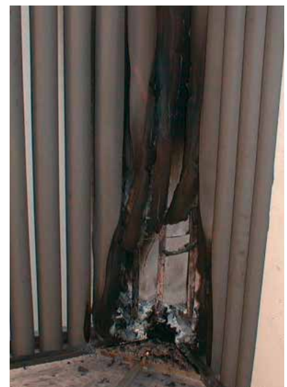
Figure 2: Le test SBI – illustré ici par des tubes en élastomère - avant, pendant et après le test
