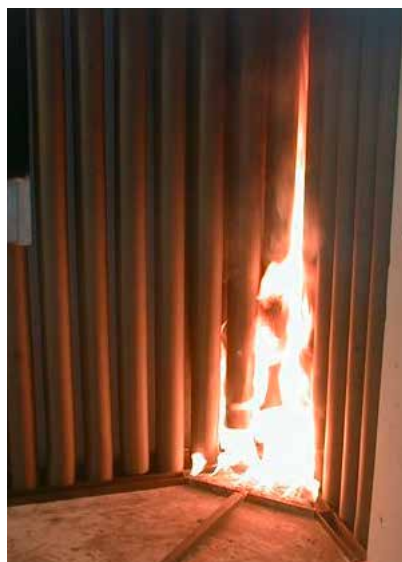
Figure 2: Le test SBI – illustré ici par des tubes en élastomère - avant, pendant et après le test
