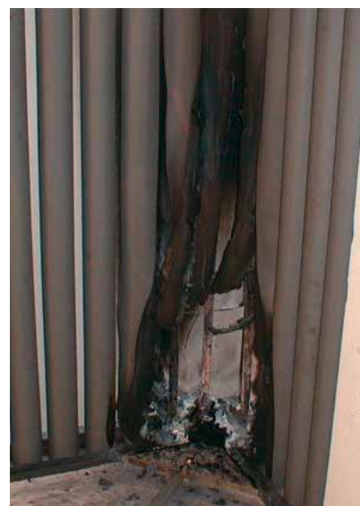
Kuva 2: SBI-testi – kuvattu tässä elastomeeriputkien kanssa – ennen testiä, sen aikana ja testin jälkeen.
