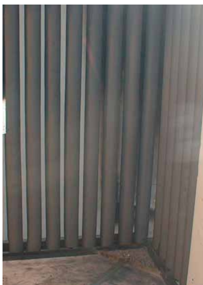
Kuva 2: SBI-testi – kuvattu tässä elastomeeriputkien kanssa – ennen testiä, sen aikana ja testin jälkeen.
