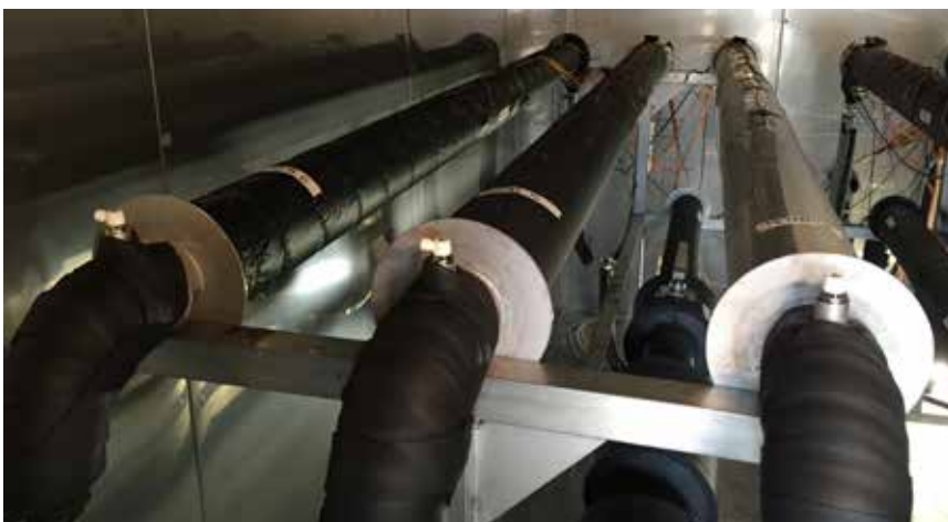
Kuva 3: Testijärjestely: Testinäytteet sääkammiossa
