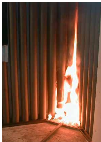
Abbildung 2: Der SBI-Test – hier am Beispiel von elastomeren Schläuchen – vor, während und nach dem Test
