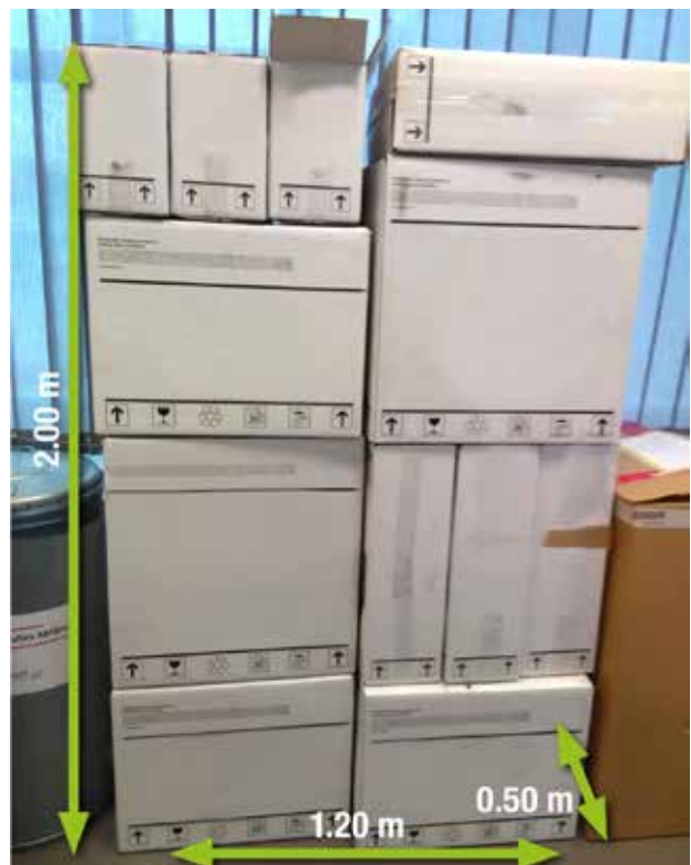
Nicht gerade platzsparend: Beim Einsatz von Schaumglas muss auf der Baustelle für ausreichend Lagerraum gesorgt sein
