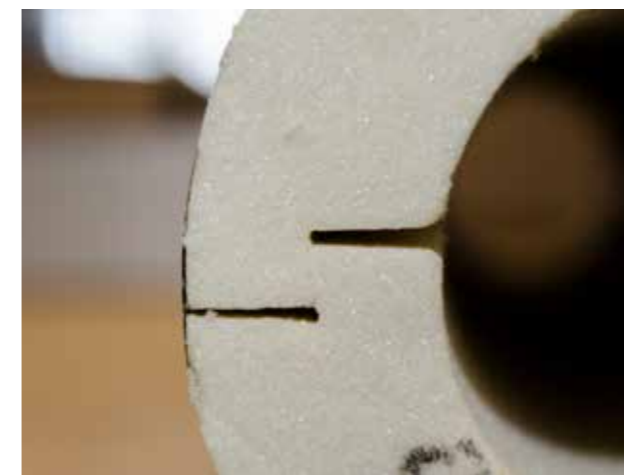
PUR/PIR-Hartschaum besitzt einen geringen Wasserdampfdiffusionswiderstand und benötigt daher eine wirksame Dampfbremse
