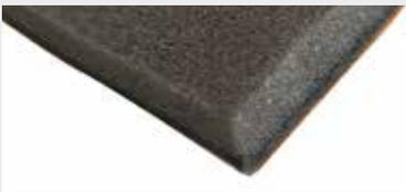
Unsere neueste Innovation vereint die hervorragende Schallabsorptionsleistung eines Polyurethanschaums und den Transmissionsverlust einer schweren Masseschicht in einem Produkt. Die mehrschichtige Dämmung besteht aus einem PU-Schaum und einer 2 mm dicken Schallbarriere und ist mit einer selbstklebenden Folie für diesaubere und schnelle Installation auch in engen Räumen ausgestattet.
