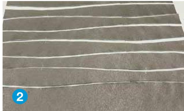
Erzeugen Sie Segmentschablonen mit ArmaFlex Ultima C. Füge auf beiden Seiten 10 mm mehr hinzu, um eine Überlappung von 20 mm zu erhalten.
