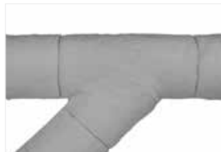
Afbeelding 53: Installatie van de schuine aftakking en vastzetten met draadband om alle voegen stevig en zonder openingen te sluiten.
