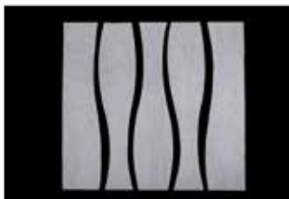
Afbeelding 34: Snijd de sleuf exact passend voor de omtrek van de leiding. Denk eraan dat een half begin-/eindstuk mogelijk moet zijn.
