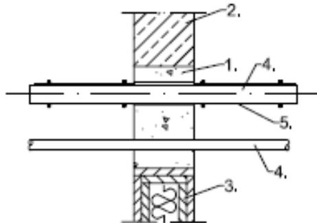
Conducto de instalación eléctrica  $\varnothing \leq 32$  mm, haces de conductos  $\varnothing \leq 100$  mm
