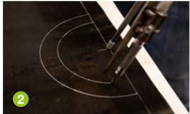
Dibuje un semicírculo (diámetro D como en la imagen anterior) en un extremo de la plantilla preparada para la parte del cuerpo. Dibuje un semicírculo más pequeño a una distancia de 20 mm y recorte el semicírculo interior. Repita este paso en el otro extremo de la plantilla.
