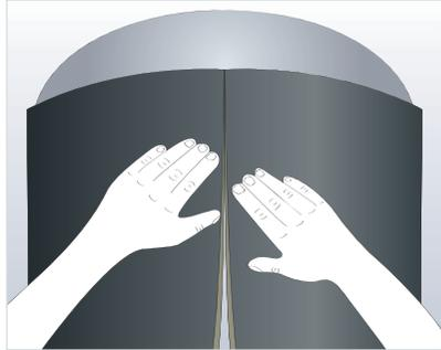
2. 측정된 수치대로 Armaflex Sheet를 재단하십시오. Armaflex 접착제를 Armaflex Sheet에 먼저 도포한 다음, Tank 표면에도 도포하십시오. 접착제가 도포된 Armaflex Sheet가 건조되면 부착 위치에 놓고 단단하게 압착하여 접합하십시오.
