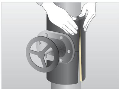
재단된 Valve 커버를 Valve에 맞추어 장착하고 Armaflex 접착제를 Valve 커버의 모든 접합부에 얇게 도포하십시오. 접착제가 건조되면 접합하시기 바랍니다.
