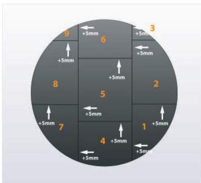
किनारों पर लगने वाली शीट का उपयुक्त नाप लेने के लिये व्हेसल बॉडी के बाहरी किनारों पर रखकर चॉक से रेखांकित करे।
